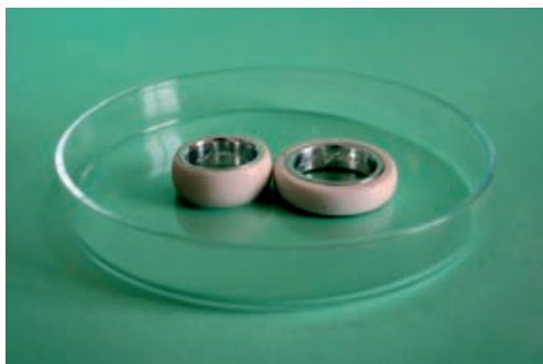
La pre-forma utilizzata per far crescere la coltura delle cellule di tessuto osseo e i primi prototipi
